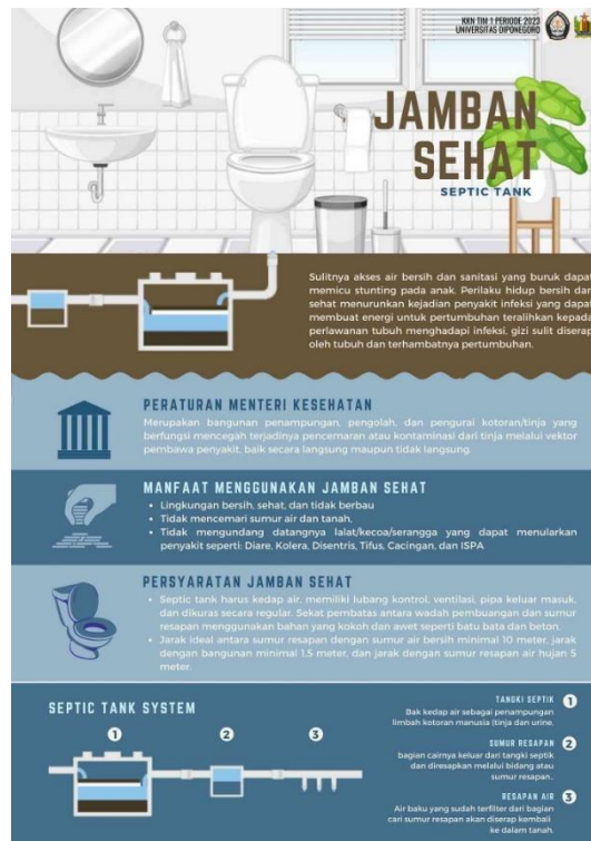
Gambar 6. Septic Tank Jamban Sehat
